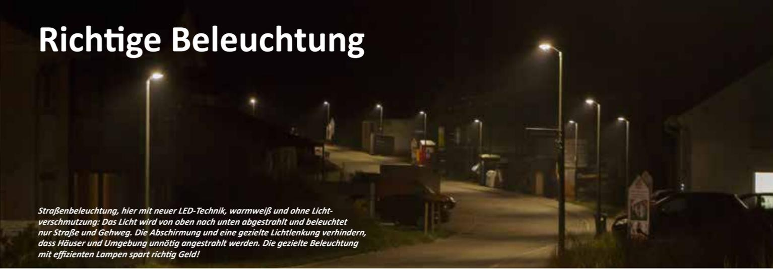
*Straßenbeleuchtung, hier mit neuer LED-Technik, warmweiß und ohne Lichtverschmutzung: Das Licht wird von oben nach unten abgestrahlt und beleuchtet nur Straße und Gehweg. Die Abschirmung und eine gezielte Lichtlenkung verhindern, dass Häuser und Umgebung unnötig angestrahlt werden. Die gezielte Beleuchtung mit effizienten Lampen spart richtig Geld!*
